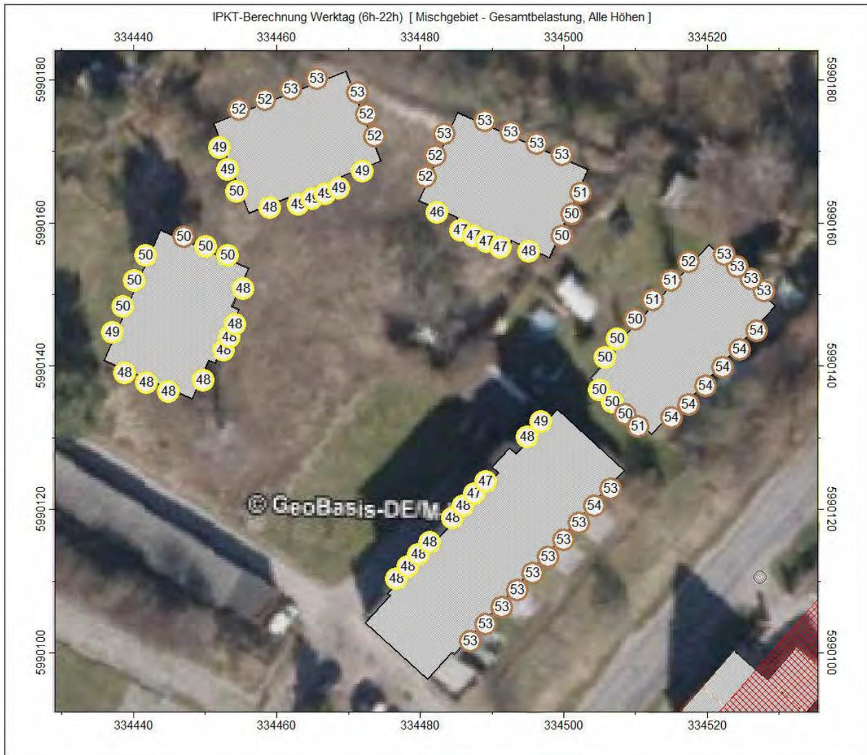
**Abbildung 8: Beurteilungspegel L<sub>r</sub> der Gesamtbelastung in dB(A); Zeitraum Werktag 06:00 bis 22:00 Uhr; bestehenden sowie geplanten Wohnbebauungen innerhalb des Plangebietes; Gebietseinstufung als Mischgebiet**
